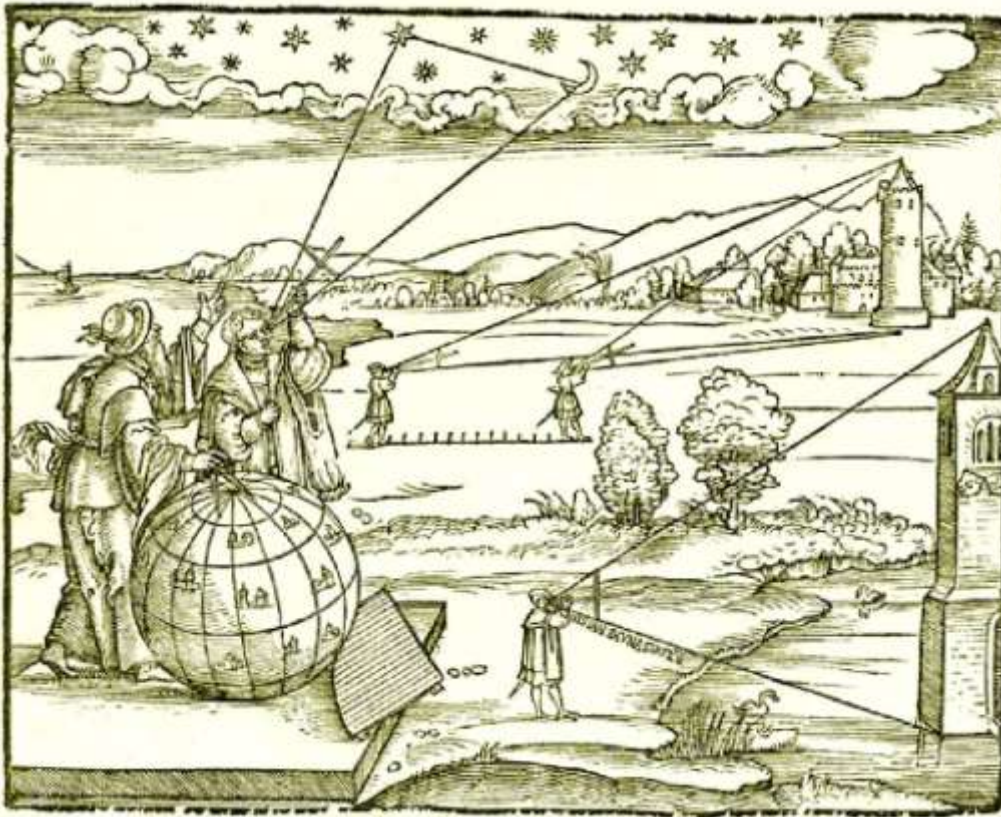
Figura 9. Uso del baculo, illustrazione del frontespizio da Apian (1533).
