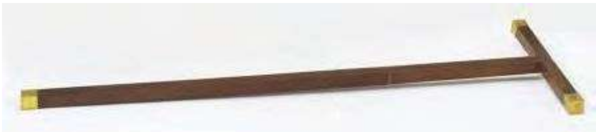
Figura 7. Bastone di Giacobbe (telescopico), attr. Christoph Schissler, fine sec. XVI, Firenze, Museo Galileo – Istituto di Storia della Scienza.
